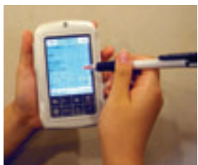
見やすい画面をタッチすることで、ボタン式の押しミスがなくなったオーダー用の新ハンディターミナル。ここで入力された情報が、無線LANによって各ディスプレイに送られます。
