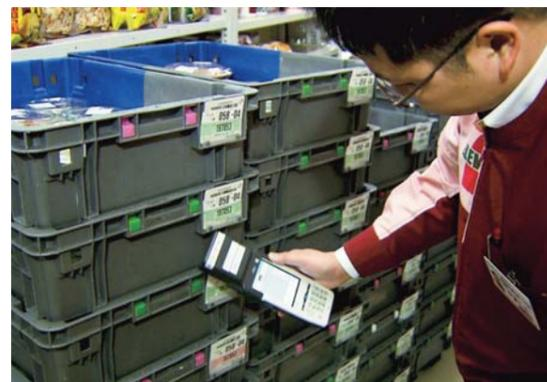
「RFID」による検品では、センターでの仕分け時にICタグで商品と納品ケースを紐づけし、店舗への納品時にデータを読み取ることで、作業を省力化。
